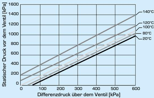
Maximaler Differenzdruck ab dem Kavitation auftreten kann, abhängig von Eingangsdruck und Wassertemperatur. Abhängig vom Eingangsdruck des Ventils und der Wassertemperatur.
