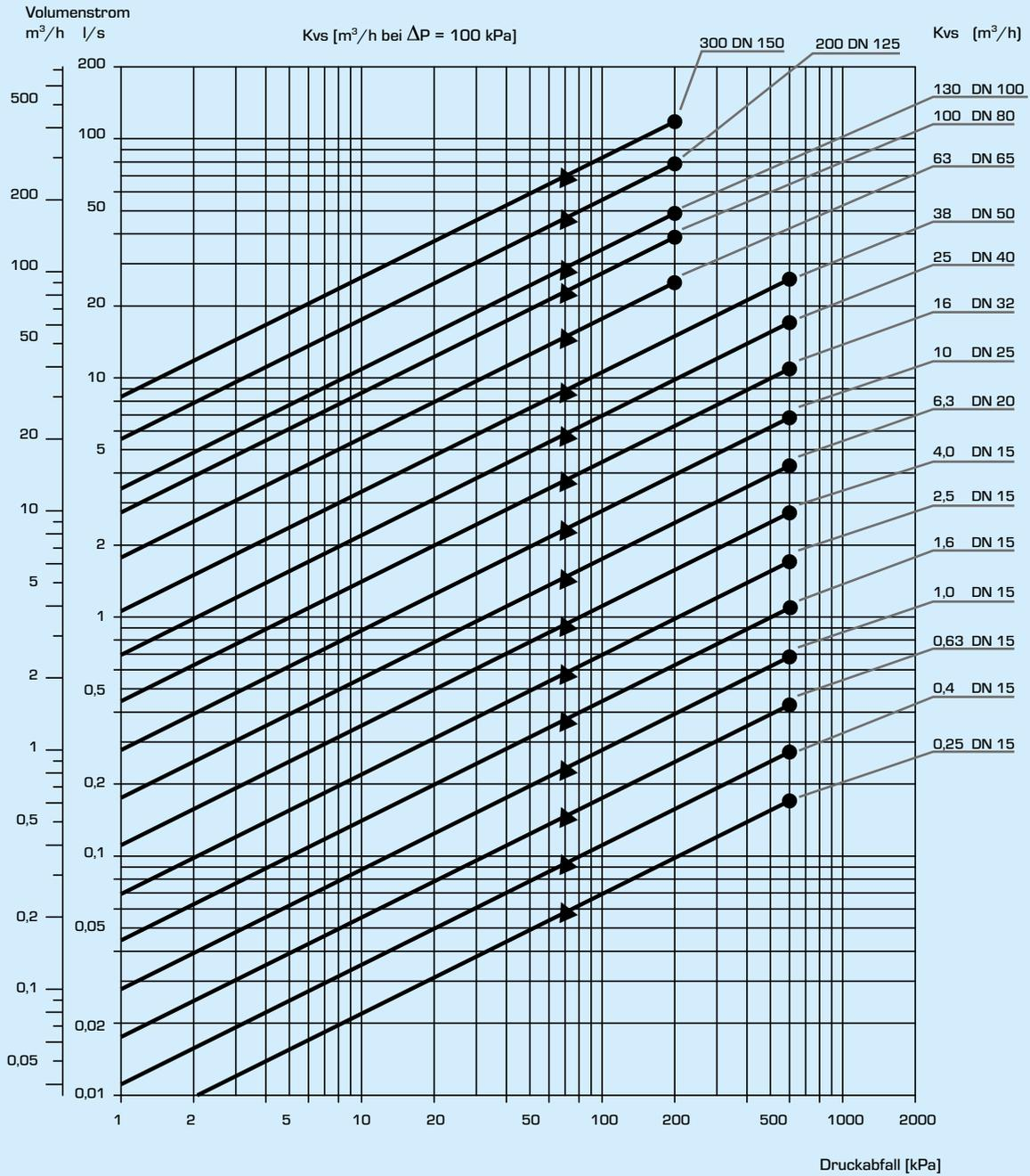
Die Zugabe von Glycol zum Heizungswasser wirkt sich sowohl auf die Viskosität, als auch auf die Wärmeleitfähigkeit aus. Dies ist bei der Dimensionierung des Ventils zu berücksichtigen. Glycolanteile < 30 % können i.d.R. vernachlässigt werden. Bei einem Glycolanteil > 30 % hat sich die Wahl eines um einen Kvs-Wert größeren Ventils als vorteilhaft erwiesen.
