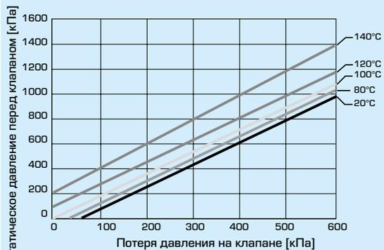
Максимальные потери давления на клапане, ведущие к возможности появления эффекта кавитации. Это зависит от входного давления на клапане и температуры воды.
